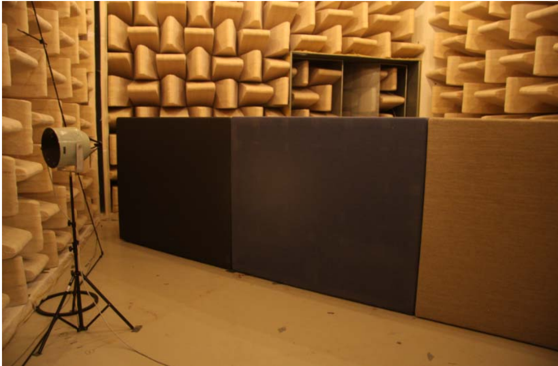
Bild 5 – Provuppställning för mätning av Sofa Sound Booth. Ljudkällan kan ses på bilden.
