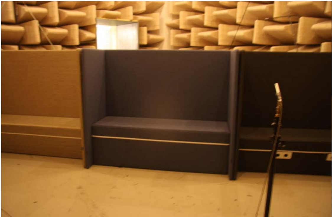
Bild 6 – Provuppställning för mätning av Sofa Sound Booth. Standardmikrofonpositionen kan ses på bilden.
