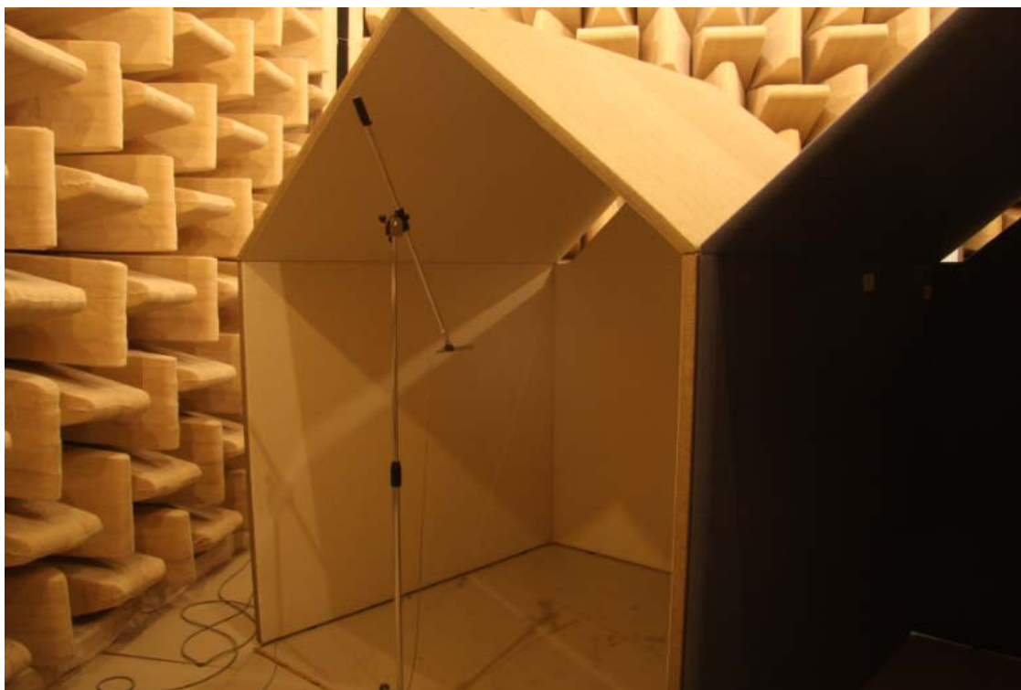
Bild 3 – Prouppställning för mätning av The Hut – i huset. Standardmikrofonpositionen kan ses på bilden.
