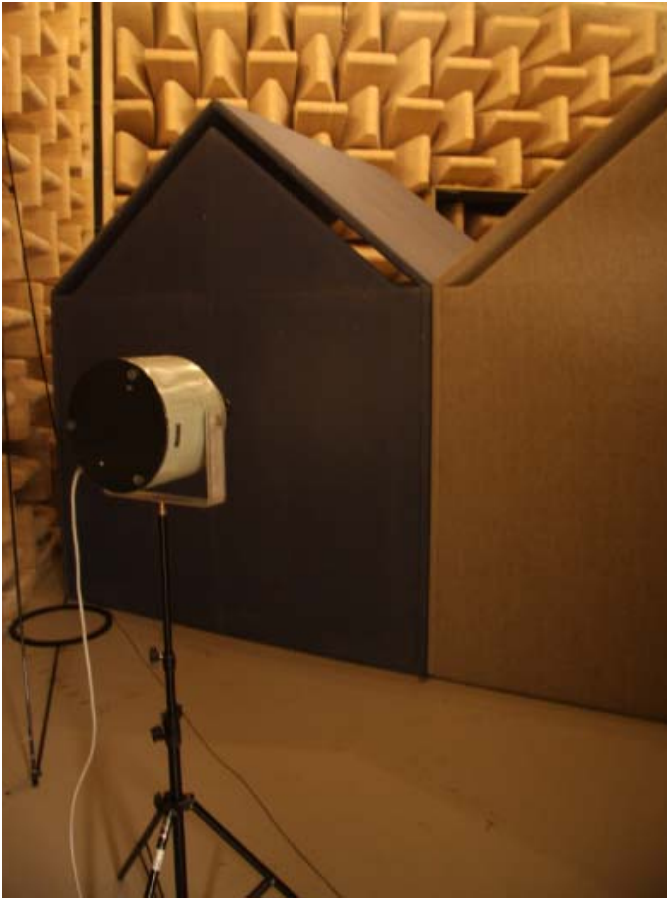
Bild 1 – Prouppställning för mätning av The Hut – vid skarv. Ljudkällan kan ses på bilden.
