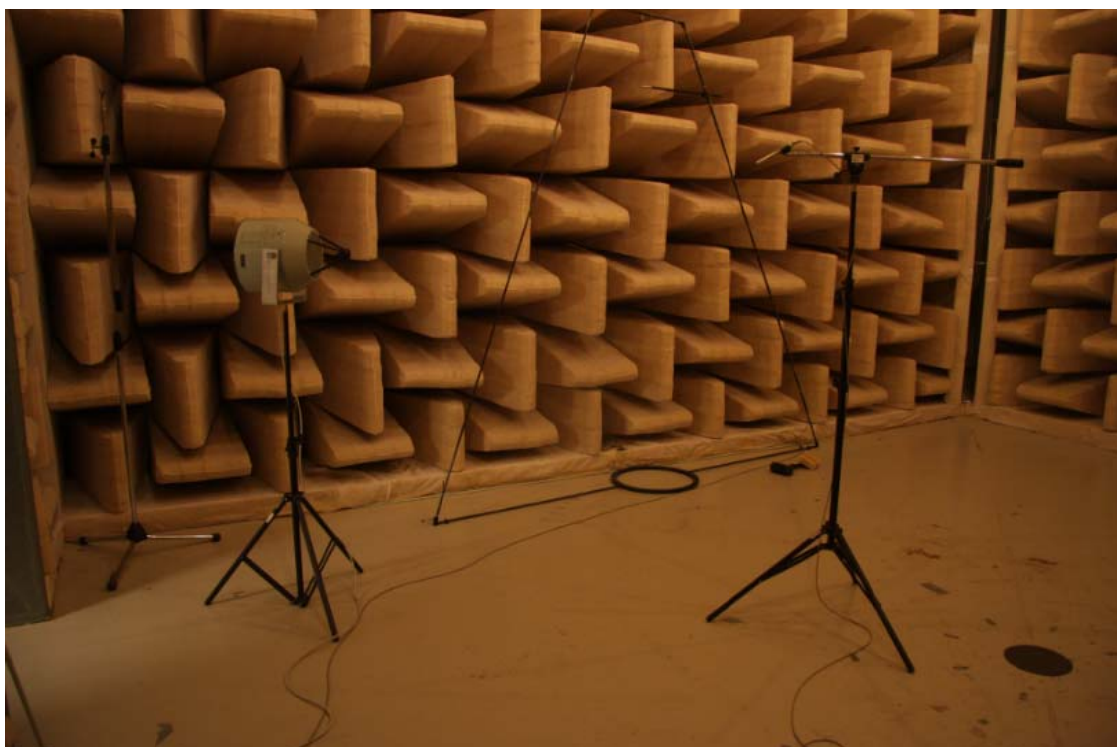
Bild 4 – Provpställning för mätning av referensmikrofonposition för The Hut – vid skarv.
