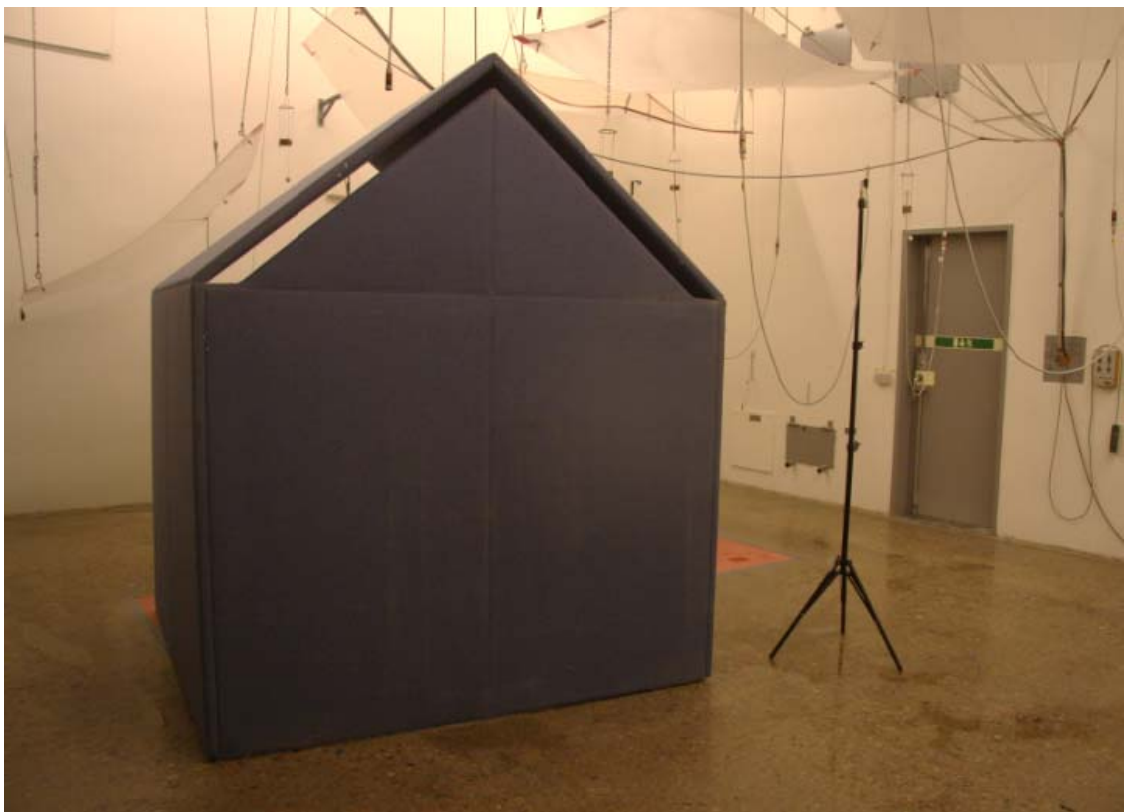
Bild 4 – Ett provobjekt av typen The Hut testades i tre olika positioner. The Hut ses här bakifrån.
