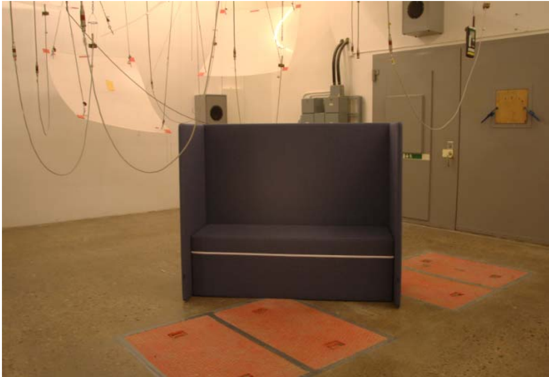
Bild 7 – Ett provobjekt av typen Sofa Sound Booth testades i tre olika positioner
