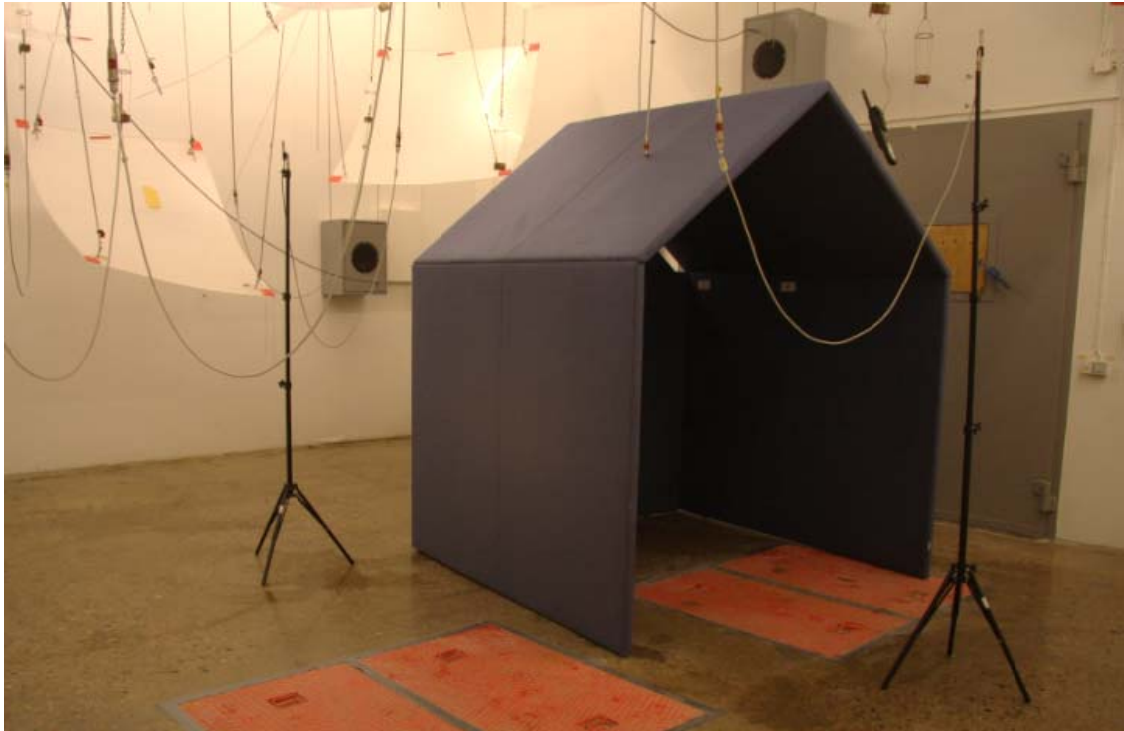
Bild 3 – Ett provobjekt av typ The Hut testades i tre olika positioner. The Hut ses här snett framifrån.
