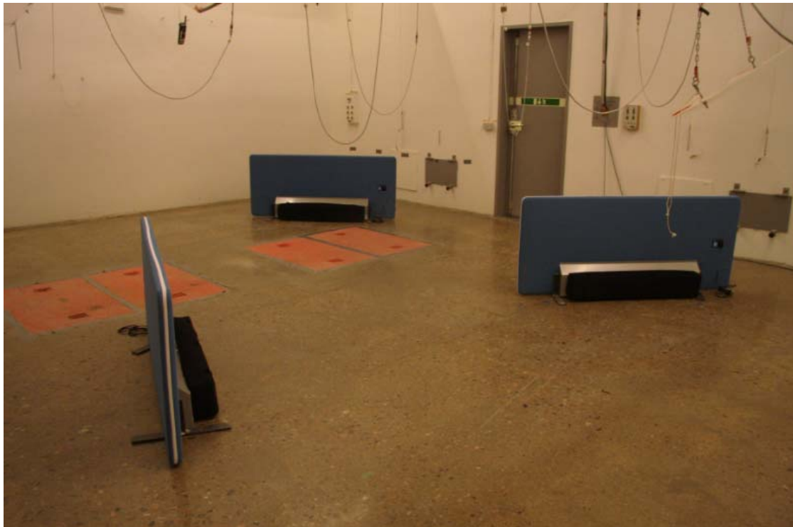
Bild 2 – Tre stycken provobjekt av typen PAZ Bordsskärm testades.
