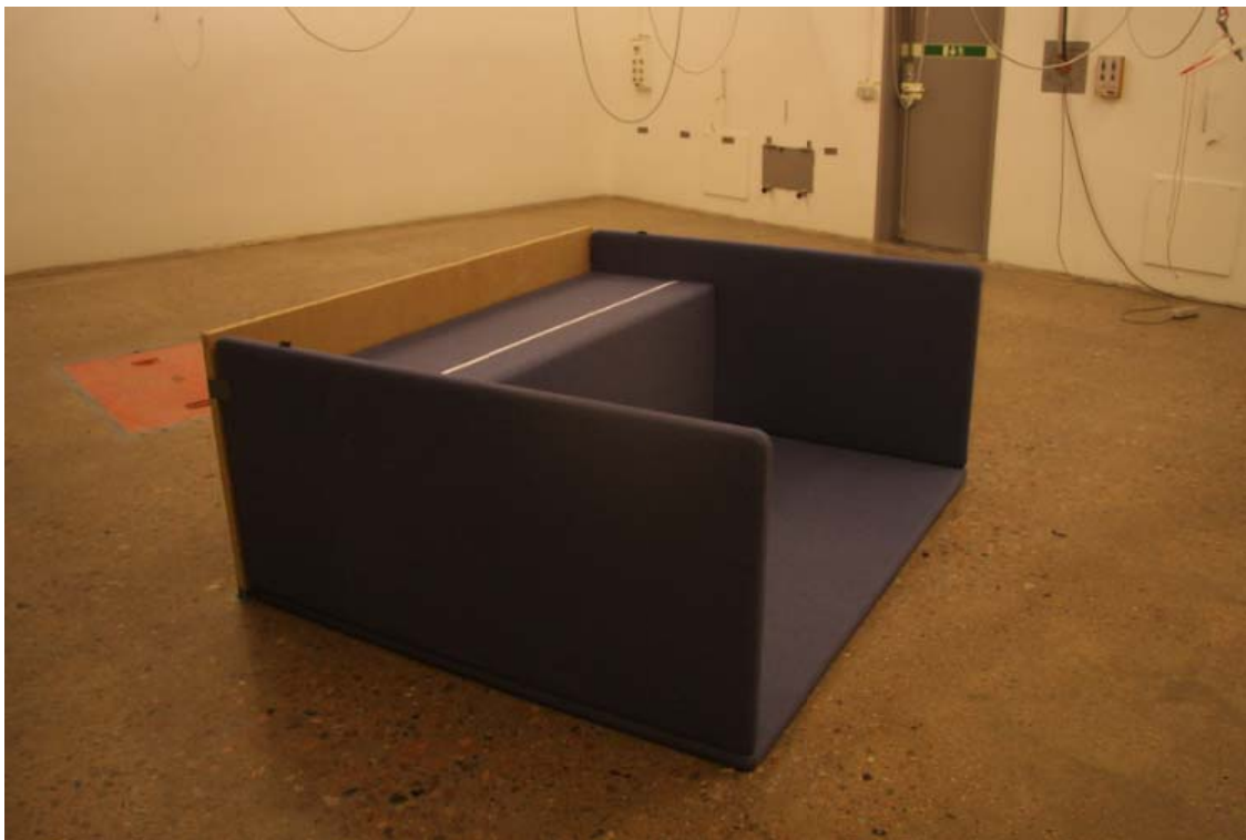
Bild 8 – Sofa Sound Booth testades även liggandes med baksidan mot golvet och undersidan täckt med en skiva. Mätningen motsvarar placering av Sofa Sound Booth mot vägg eller liknande.
